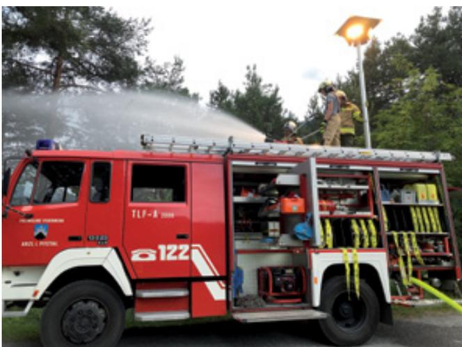
Umgang mit dem Monitor am Dach des Tanklöschfahrzeuges
