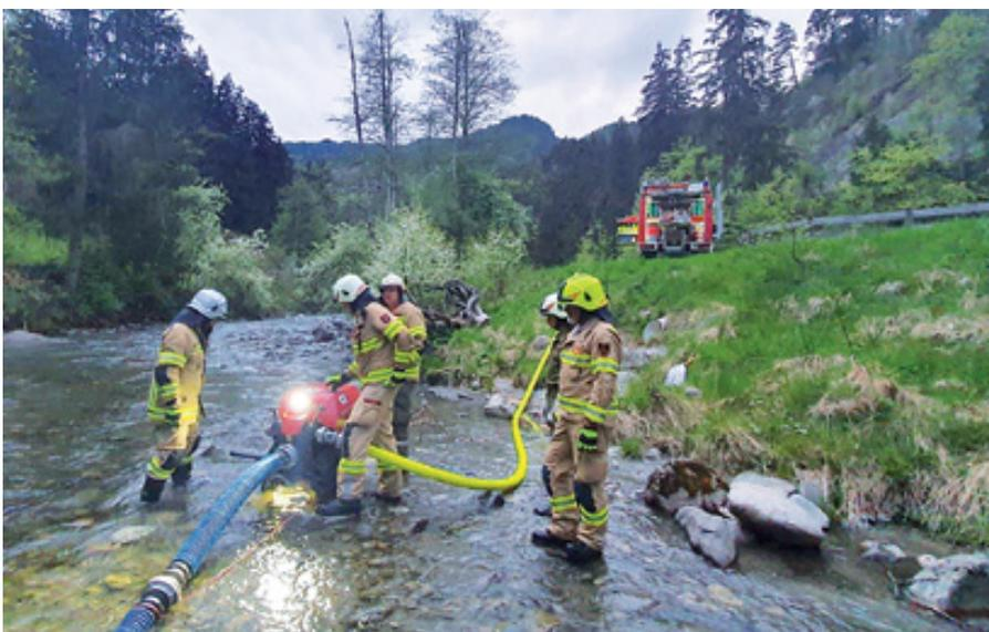
Ansaugen mittels Tragkraftspritze an der Pitze
